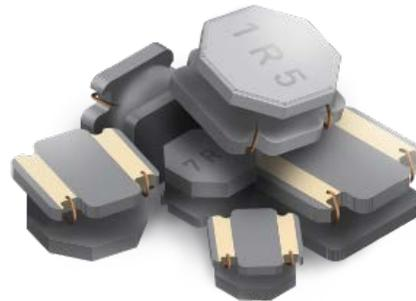
MPL-SE半屏蔽式功率电感外部使用电磁环氧树脂材料，具有更好的导磁特性。其优化的设计降低了DCR，提高了电流能力
